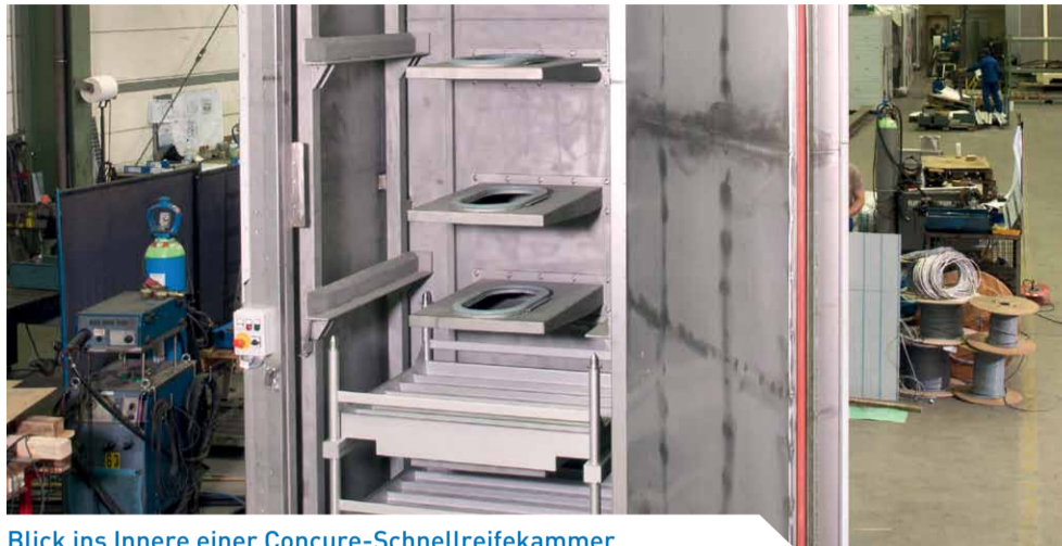
Blick ins Innere einer Concure-Schnellreifekammer
