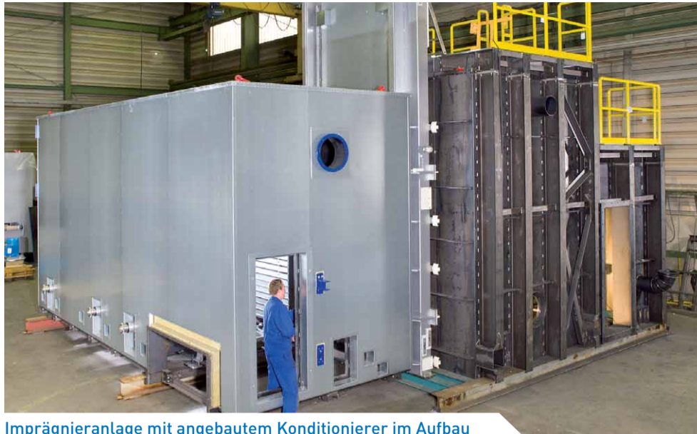
Imprägnieranlage mit angebautem Konditionierer im Aufbau
