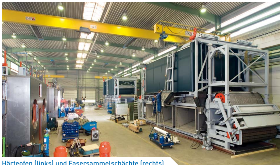
Härteöfen (links) und Fasersammelschächte (rechts) während der Montage bei Münstermann
