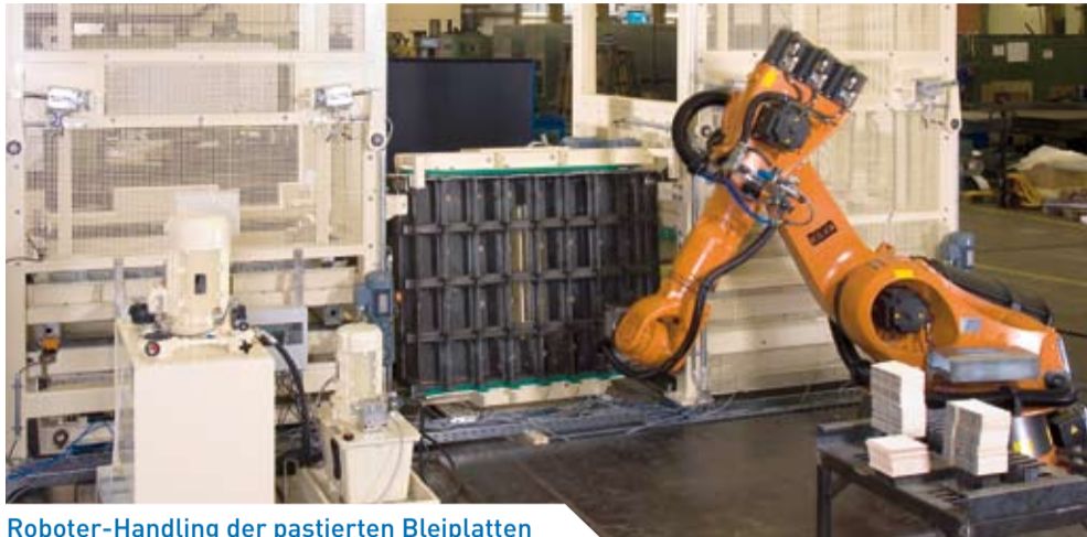
Roboter-Handling der pastierten Bleiplatten Das Beladen der Paletten mit den pastierten Platten geschieht vollautomatisch
