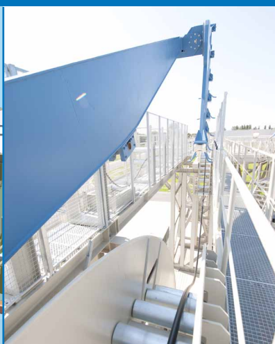
Zwischenspeicher bei der Kabelherstellung (Tänzer)
